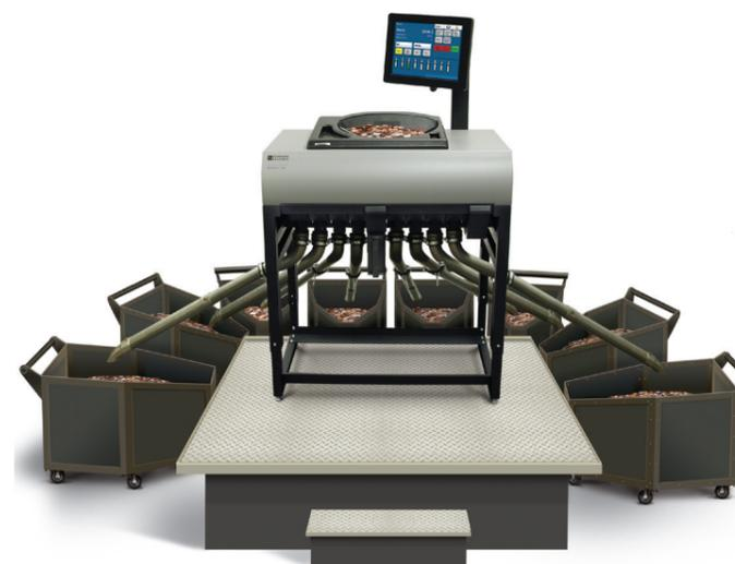
JetSort LXC è disegnata per essere collegata anche a tubi in uscita, rigidi o flessibili, in modo da riempire direttamente i carrelli su ruote. La possibilità di regolazione in altezza consente di lavorare con ogni tipo di carrello.
